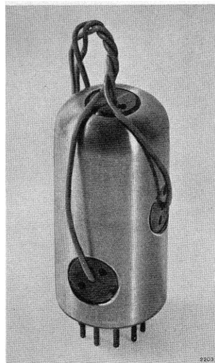
Fig. 2. Combinatie van drie trillingsopnemers, die wordt gebruikt voor het meten van de trillingen waaraan buizen in elektronische apparaten zijn onderworpen. Het geheel kan in plaats van een buis in een buishouder worden gestoken.
